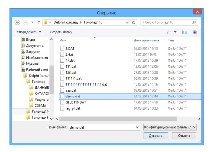
В открывшимся окне выбрать необходимую папку и отметить файл с импортируемыми данными. Необходимые данные хранятся в файлах с расширением «\*.dat» для плавки переменным током (программа «Гололед 110») и для плавки гололеда на тросах («Гололед Трос»). Для плавки постоянным током (программа «Гололёд») файлы с данными имеют расширение «\*.gld». Для продолжения работы нажать на кнопку **Открыть**.
